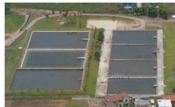
図 1：1910（明治 35）年から現在まで、現役でおいしい水を給水し続けている高崎市の剣崎浄水場。左は、沈澱池、右は緩速ろ過池。台風で河川水が濁っても沈澱池だけで対処する。
