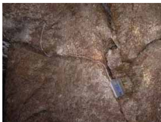
温湿度センサーを壁面に固定した様子
